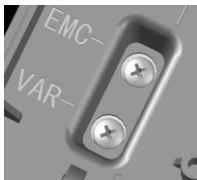
塑壳机箱限位螺钉示意图
