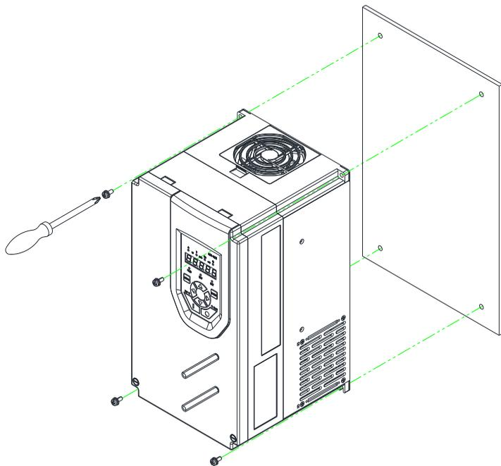
图 3-6 Hope510G11T4~Hope510G375T4 机型壁挂式安装
