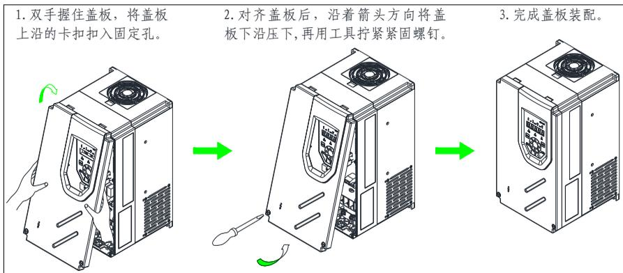
图 3-10 Hope510G11T4~Hope510G37T4 机型盖板拆卸与安装步骤
