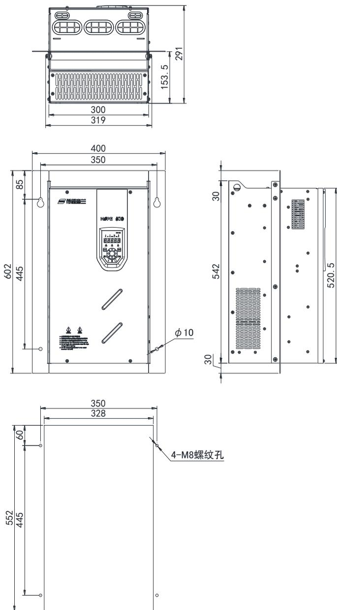
H510-A-4 安装挂条及开孔尺寸示意图
