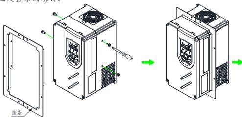
3. 将装好挂条的变频器固定在安装柜的固定面上。
