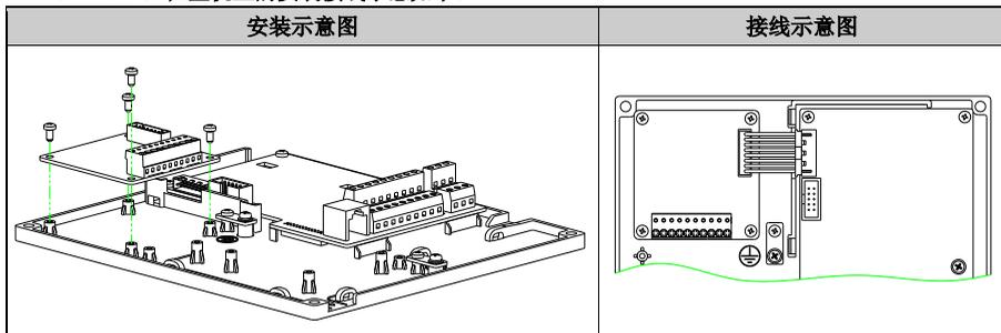
SL530-PG1在整机上的安装接线示意如下：
