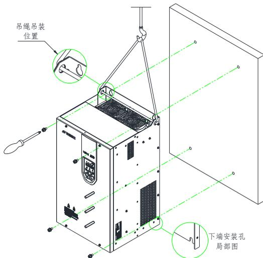
图 3-7 Hope510G45T4~Hope510G375T4 机型壁挂式安装
