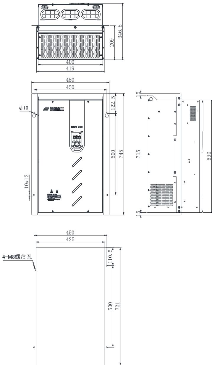
H510-A-6 安装挂条及开孔尺寸示意图
