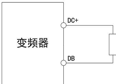
无内置制动单元的变频器,需使用SZ20G系列制动单元和制动电阻。制动电阻阻值不得小于推荐值,否则有损坏变频器的可能。制动电阻功率必须根据实际负载的发电工况(发电功率大小、发电频繁程度等)确定。
