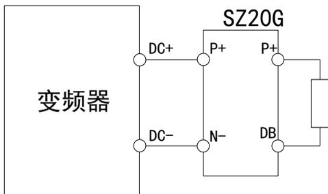
制动单元和变频器、制动单元和制动电阻之间的接线应在5m以内,并且使包围回路面积最小。
