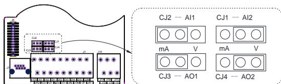
Hope510G系列控制板端子排列（建议使用1mm 的铜导线）：
