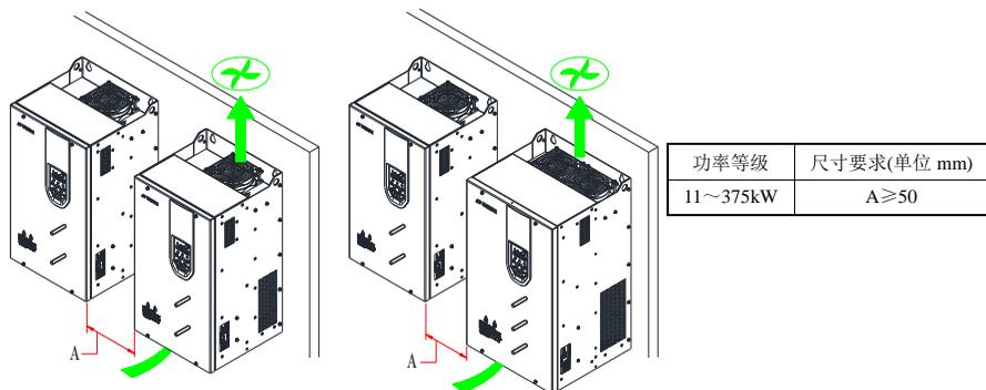
图 3-3 Hope510G11T4~Hope510G375T4 多台机器并排安装
