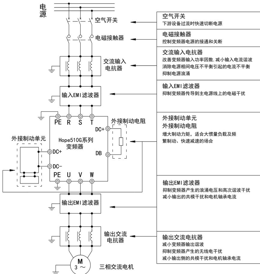
图3-12 Hope510G系列变频系统连接示意图
