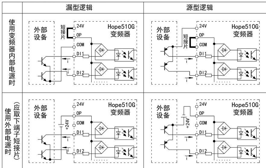
多功能输出端子和外部设备的连接：
