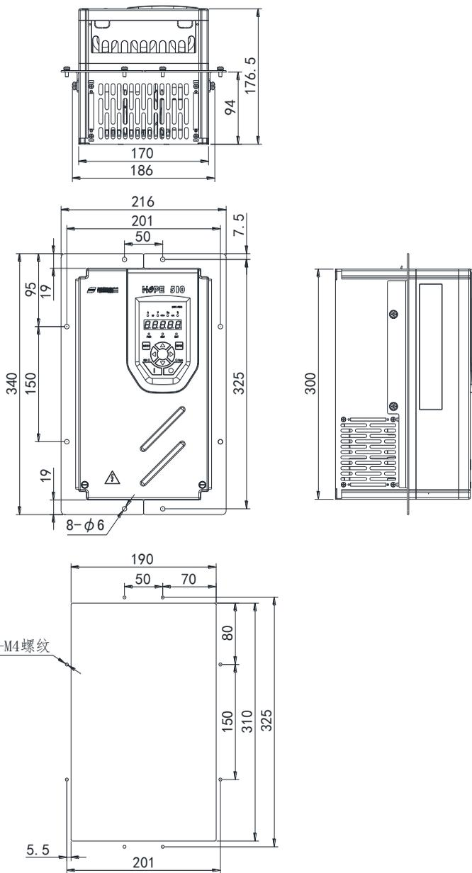
H510-A-1 安装挂条及开孔尺寸示意图
