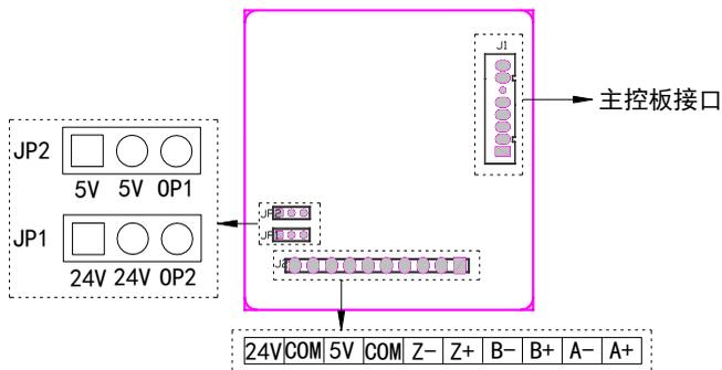
安装方法：（1）确认变频器断电；（2）按照编码器安装示意图安装编码器信号转接板；（3）按照编码器接线示意图所示的方法将SL510-PG0扩展板与控制板连接起来。
