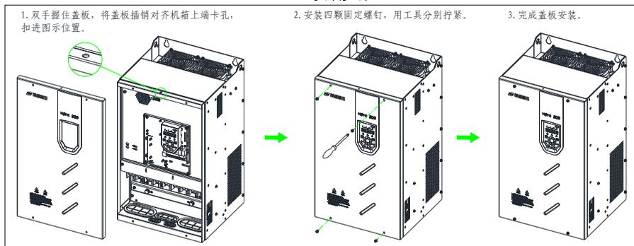
图 3-11 Hope510G45T4~Hope510G375T4 机型盖板拆卸与安装步骤
