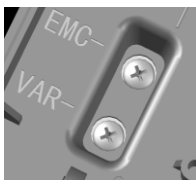
塑壳机箱限位螺钉示意图
