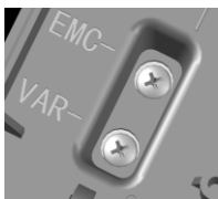
塑壳机箱限位螺钉示意图
